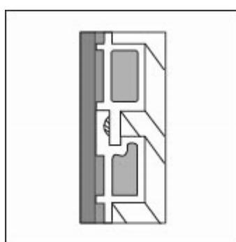
Das nächste Panel stecken Sie in das bereits befestigte Panel. Die Feder des zweiten, neuen Panels verdeckt die Schraube des ersten Panels.
