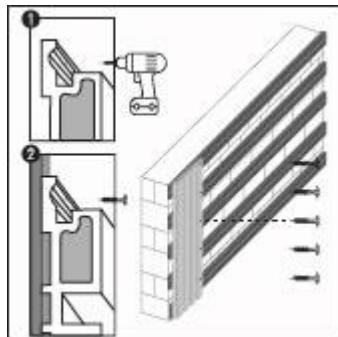
Schrauben Sie das Wandpaneel auf der Unterkonstruktion fest. Die Schrauben werden dazu durch die Klickverbindung (Nut) in das Panel geschraubt.
